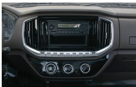
Hệ thống điều hòa và giải trí
