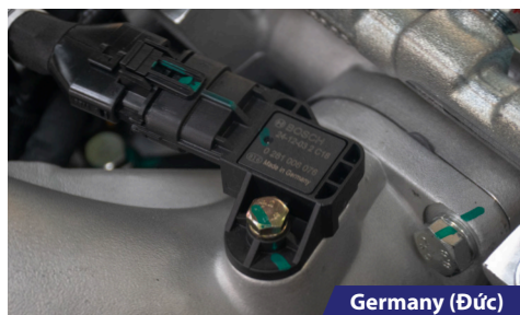
Cảm biến lưu lượng khí nạp Bosch
